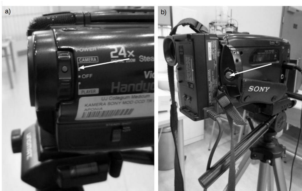
Rysunek 5. a) przelącznik otwierający obiektyw kamery (ustawiony na pozycji CAMERA), b) przelącznik obok okularu ustawiony w pozycji StandBy.
