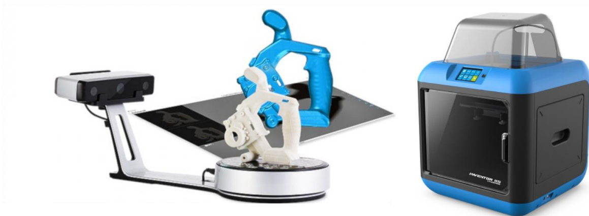
Rys. 1. Układ doświadczalny: Skaner Shining 3D EinScan SE i drukarka 3D
