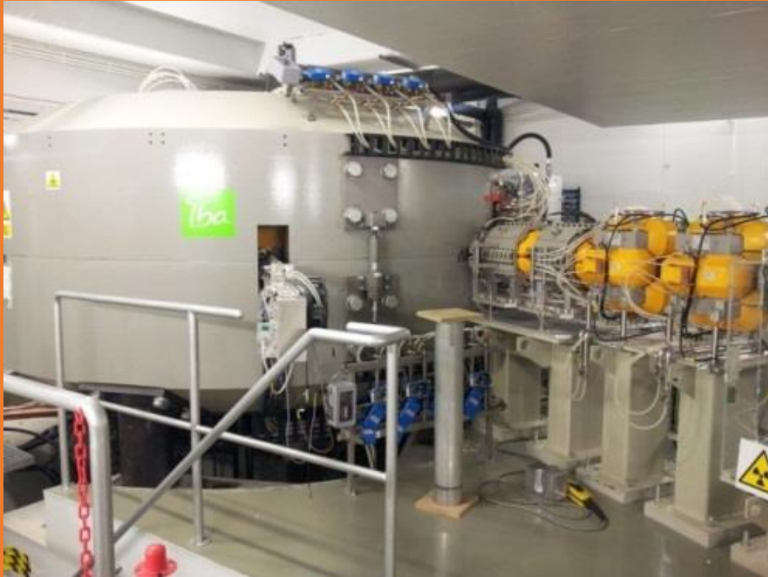
Widok cyklotronu w Instytucie Fizyki Jądrowej w Krakowie wykorzystywany w radioterapii protonowej
